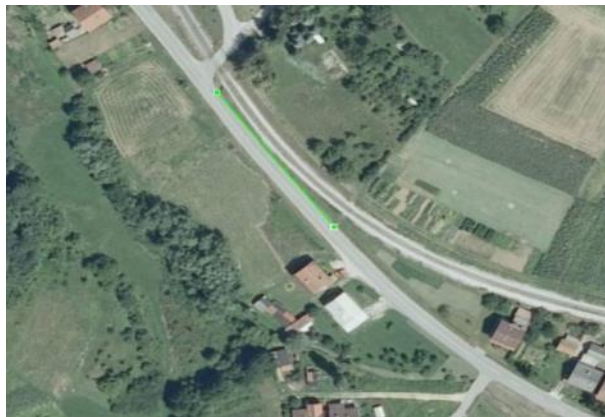
Slika br. 10 - Km 24+271 do km 24+352, odvodnja između pruge i ceste
